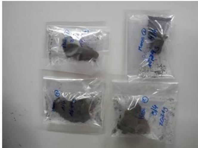
**Abbildung 6.1: Probenaufteilung für die Gammaskpektrometrie-Messungen**
