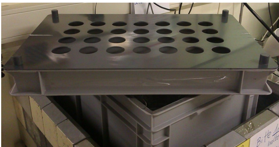
Abbildung 38: Deckel mit 28 Löchern für Aktivkohlefilter.
