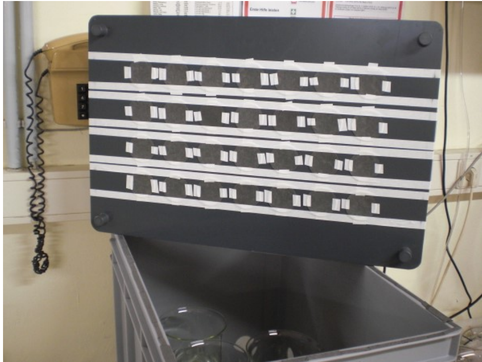
Abbildung 39: Deckel mit Aktivkohlefiltern.
