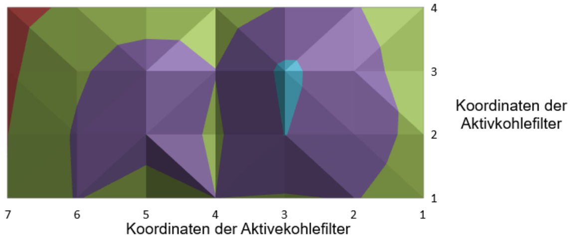
Abbildung 46: Zählraten der Aktivkohlefilter im Deckel der Box. Mit den Zählraten ■ 1000 - 800 cps, ■ 800 - 600 cps, ■ 600 - 400 cps, ■ 400 - 200 cps und ■ 200 - 0 cps.
