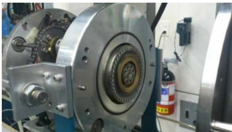
Abbildung 18: Probenrad der Ionenquelle der AMS [23].
