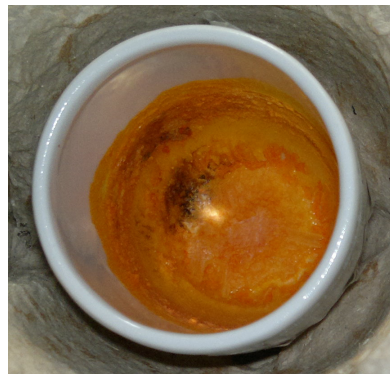
Abbildung 4.4: Eisenhydroxid vor dem Brennen der Probe (erhöhte Eisenzugabe)
