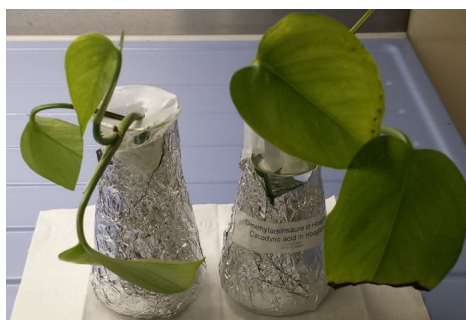
Abbildung 3.2.: Versuchsaufbau der Vorversuche mit Epipremnum aureum L.; Links: Kontrollpflanze; Rechts: Kontamination der Pflanze mit Dimethylarsenat.
